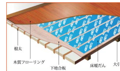
施工イメージ
