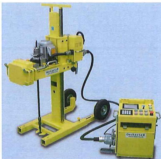
スウェーデン式サウンディング試験機 （機械式調査機械：ジオカルテⅢ～日東精工(株)製）
